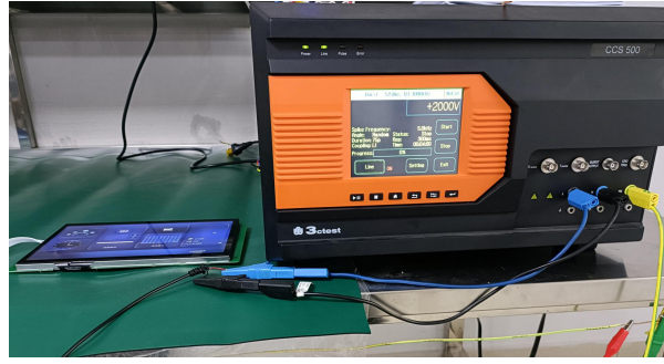
3.2 群脉冲测试图 EFT test
