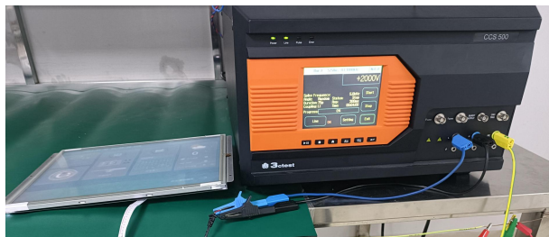
3.2 群脉冲测试图 EFT test
