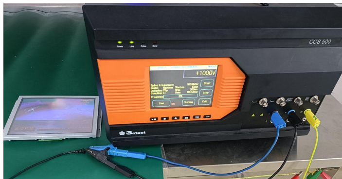
3.2 群脉冲测试图 EFT test
